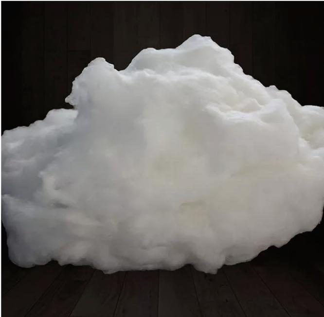
Fibra cerâmica refratária (RCF) a granel ou lã de silicato de alumínio são produzidos com caulim ou mistura de sílica e alumina, ambos com capacidade de temperatura de até 1425°C
